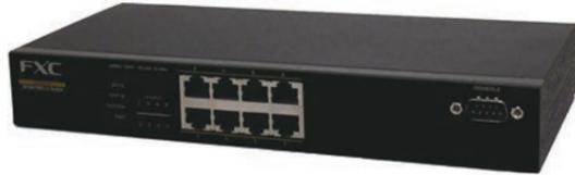
ES1008VL3は、10BASE-T/100BASE-TX/1000BASE-T 8ポート搭載した、ギガイーサネットスマートスイッチです。VLAN機能は、フレキシブルなネットワークの構築を可能にし、QoSはVoIP等の音声ネットワークにおいて、音声データの優先処理を行うことで、よりスムーズなフレーム転送を確保します。
