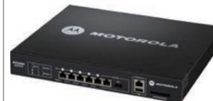
RFS4000は1台あたり最大6台までの専用アクセスポート(AP650)を管理できる小中規模向け無線LANスイッチです。支店、店舗などの小規模事業所に、高性能で包括的、かつコストパフォーマンスに優れた、安全性の高い無線および有線のネットワークを提供します。有線インターフェイスとして1000Base-Tポートを6ポート装備し、内5ポートにて802.3af及び802.3atのPoE給電に対応しています。
