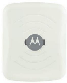
AP6532は高いスループットとWiNG5によるローカルブリッジングを含むダイレクト転送、セキュリティ、QoSサービス、およびサイトサバイビリティの機能を備えた性能重視型の802.11n対応アクセスポイントです。デュアルラジオのアクセスポイントなので2つ目の無線機はアクセス用だけでなく、トラブルシューティングやセキュリティ用のセンサとしても使用できます。またWiNG5のインテリジェンス機能により仮想コントローラとしても機能し、最大24台のアクセスポイントの管理を可能とします。
