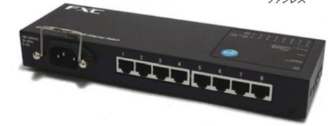
ES1008MTP2は、10/100/1000Mbpsポートを8ポート搭載したタップ型イーサネットスイッチです。各ポートはオートネゴシエーションをサポートし、ポートの通信速度、通信方式及び極性を自動的に設定することができます。又、各ポートは本体側面のスイッチにより、通信速度、通信方式を手動で設定する事ができ、それぞれのポートに対し、10/100/1000Mbps、Full/Half Duplex固定通信モードを自由に設定可能です。
