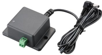
「OPT-LEX-PC03-45」はDC48V入力に対応したDCアダプタです。データセンターや工場のライン等、DC-48V電源環境において、ACアダプタと同様の使い方でLEXシリーズのラインカードを動作させることが可能です。LEDによる状態監視機構や過電流からの自動復帰機能も備えています。
