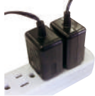
小型ACアダプタ 33.3(W)×45.4(D)×24.7(H)mm
