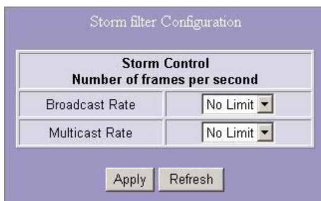
図 4-14 Storm filter Configuration 画面
