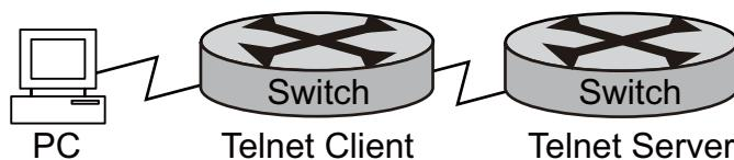
図 7 Telnet クライアントサービスの使用
