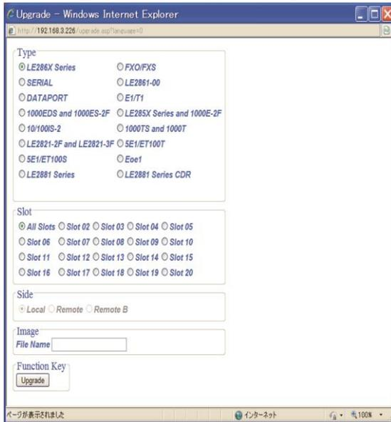
3. アップグレードしたいスロットを選択します。「全スロット」を選択すると、ローカルおよび対向側の LE284x シリーズのカードがすべてアップグレード(最大約 15 分間)されます。各スロットを選択したい場合は、ローカルか対向機側の装置を選んでください。
