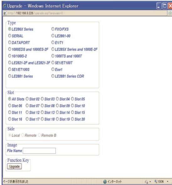
3. アップグレードしたいスロットを選択します。「全スロット」を選択すると、ローカル および対向機側の LE2000 シリーズのカードがすべてアップグレード(最大約 15 分間)されます。各スロットを選択したい場合は、ローカルか対向機側の装置を選んでください。
