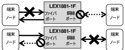
＜銅線ポートリンクダウン時の LFP 動作＞
