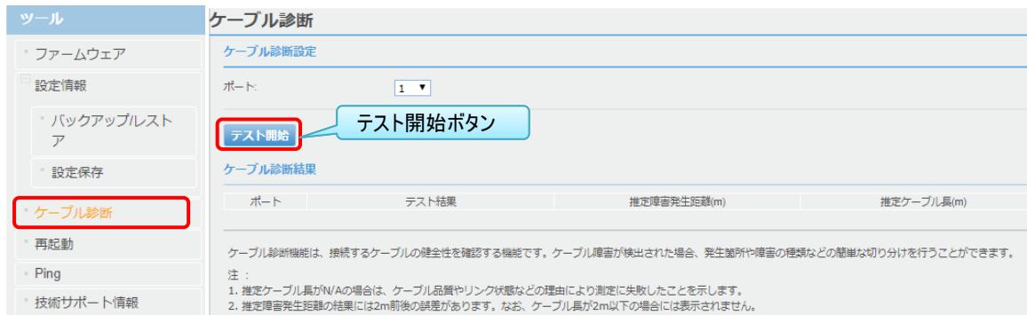
ケーブル診断機能は、ポートごとに接続されたケーブルの健全性を確認する機能です。ケーブル障害が検出された場合、発生箇所や障害の種類などの簡単な切り分けを行うことができます。
