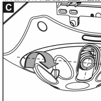
(4) 水平面の角度を調整します。
