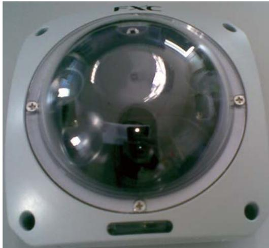
本製品は SD カードを用いた録画機能搭載ドーム型カメラです。搭載されている高性能カメラからの映像を専用 ASIC チップで H.264 方式による映像圧縮処理を行い SD カードに保存する装置です。
