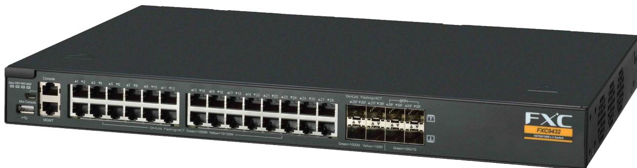
FXC9432は、10/100/1000BASE-TのRJ45ポートを24ポート、RJ45/1G SFPのコンボポートを4ポート、1/10GBASE-RのSFP+スロットを4ポート搭載した管理機能付ルーティングスタックブルスイッチです。多彩なルーティングプロトコル、IPv6ルーティングをサポートし、マルチキャストルーティングなど小規模ながらも複雑化するネットワークのコアスイッチとして機能します。ポートベースVLANの他、IEEE802.1QタグVLANやプロトコルベースVLAN、Voice VLANにも対応し、セキュリティ面でも802.1x認証の機能を持ち合わせ、ホテルやオフィス、マンション、学内など多彩なネットワーク環境にも柔軟に対応します。また、前面の10Gポートで最大4台までのハードウェアスタックが可能であり、ポート拡張や耐障害性の高いネットワーク構築を実現します。
